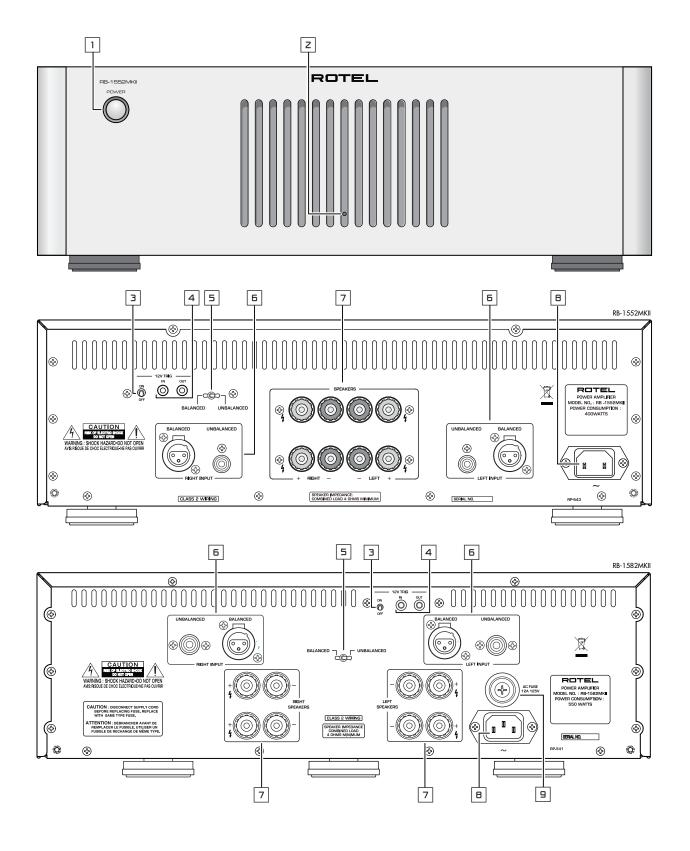
Figure 2: Analog Inputs and Speaker Output Connections Branchements des entrées analogiques et sorties enceintes acoustiques Anschlussdiagramm Conexiones Analógicas de Entrada y de Salida a las Cajas Acústicas Analoge ingangen en luidsprekeruitgangen Collegamenti ingressi analogici ed uscite diffusori Analoga ingångar och högtalaranslutningar Аналоговые входы и выходы на акустические системы
