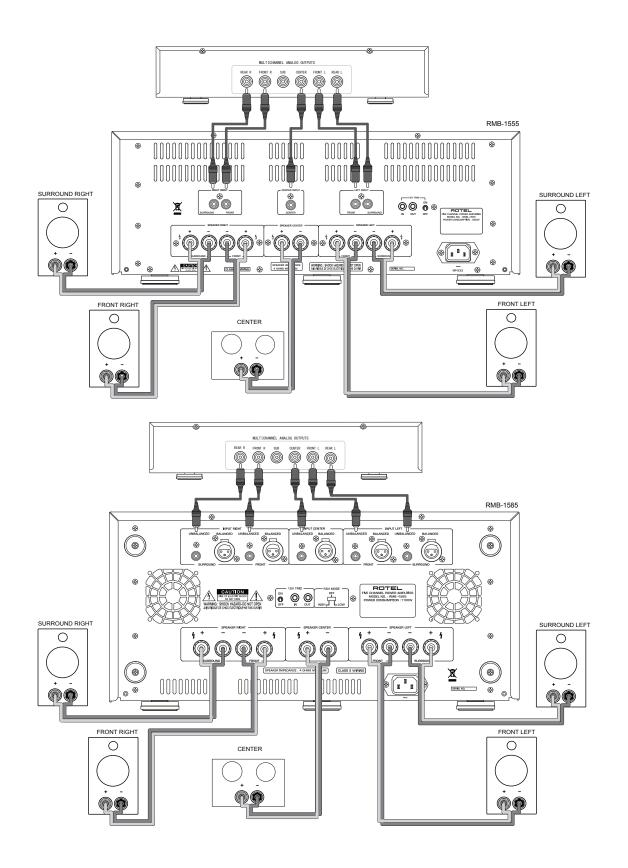
Figure 3: Balanced (XLR) Inputs Branchements des entrées symétriques (XLR) Symmetrische (XLR) Eingänge Entradas Balanceadas (XLR) Gebalanceerde ingangen (XLR) Ingressi analogici bilanciati (XLR) Balanserade ingångar (XLR) Балансные (XLR) входы
