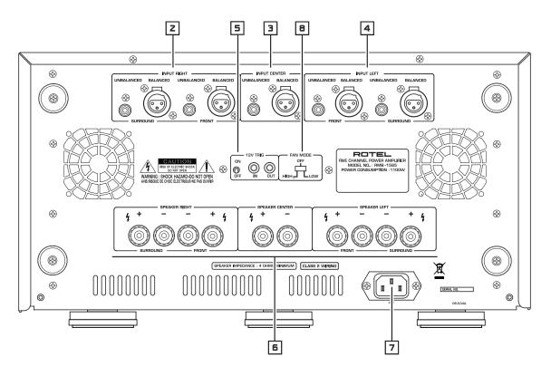
Figure 2: Analog Inputs and Speaker Output Connections Branchements des entrées analogiques et sorties enceintes acoustiques Analoge Eingänge und Anschließen der Lautsprecher Entradas Analógicas y Conexiones de Salida a las Cajas Acústicas
